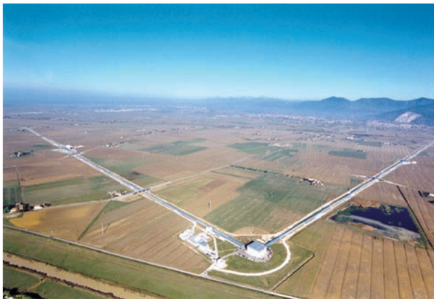
სურ. 62 ფრანგულ- იტალიური ინტერფერომეტრი VIRGO (მზრის სიგრძე – 3 კმ). მას შეუძლია 1000 კმ-მდე სიგრძის მქონე გრავიტაციული ტალღის რეგისტრაცია © CNRS/IN2P3
